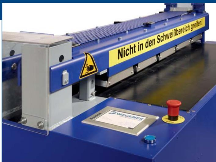
Die **WEGENER** Kompakt-Schweißmaschinen Modell SC basieren auf einer robusten Schweißkonstruktion. Wie bei allen **WEGENER International**-Maschinen sind die Maschinenkomponenten auf den jeweiligen Belastungsfall abgestimmt und sichern somit eine qualitätsoptimierte Heizelementstumpfschweißung. Die Zielsetzung bei der Entwicklung der SC Maschinenbaureihe, die in den Arbeitsbreiten 1 m, 1,5 m und 2 m verfügbar ist, bestand darin, die inno-
