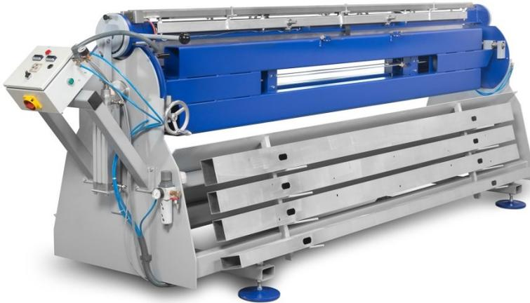
Anschlägen der Maschine ausgerichtet. Über einen 2-Handtaster wird der Einschmelzprozess gestartet und die Einschmelzeinheit wird auf das Plattenmaterial gefahren. Nach Ablauf der Einschmelzzeit fährt die Einschmelzeinheit aus dem Material heraus. Der aus Einschmelzeinheit und Ausdrückprofil bestehende Prozesskopf wird manuell um 180° geschwenkt und nach erneutem Betätigen des 2-Handtasters wird
