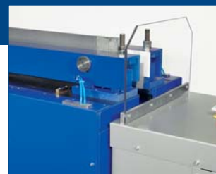
Ergonomische Reinigungsposition des Heizelementes
