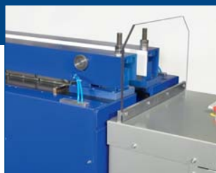
Untere Position der optional höhenverstellbaren Spannbalken
